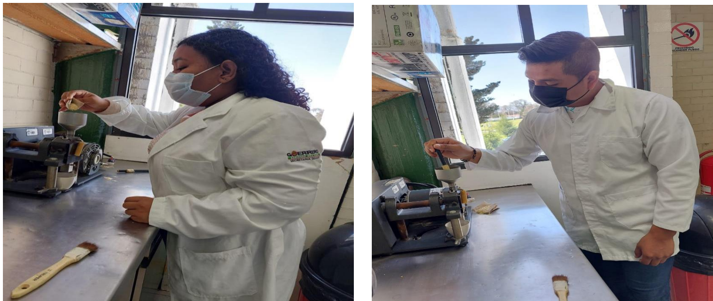
FIGURA 3. Trituración de dietas en un molino de martillos.
